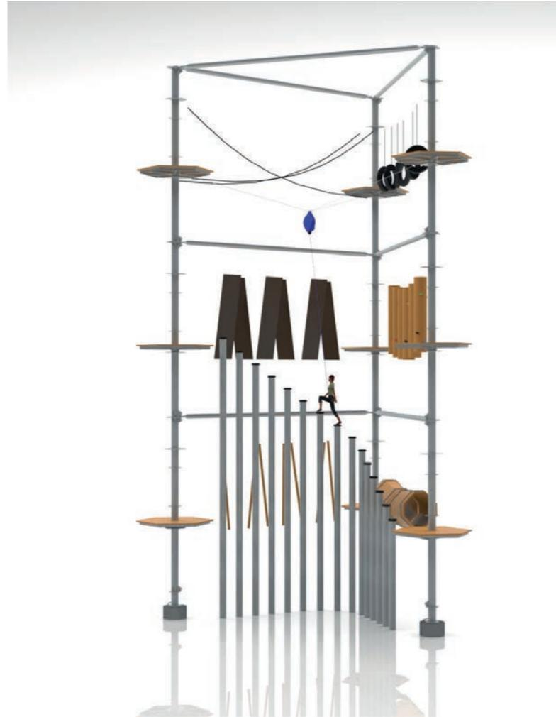
天梯方便游客从第一层攀爬至第二层。其中布置高桩，以半圆的形式高度渐增。攀爬者必须不借助工具，一步步尝试向前迈进。此时要求具备行走的稳定性和平衡度。一旦失去平衡，将在 TOPPAS 全自动保险装置的保护下返回地面。天梯装于攀爬塔的底层以内，因此不需要额外占用空间。
