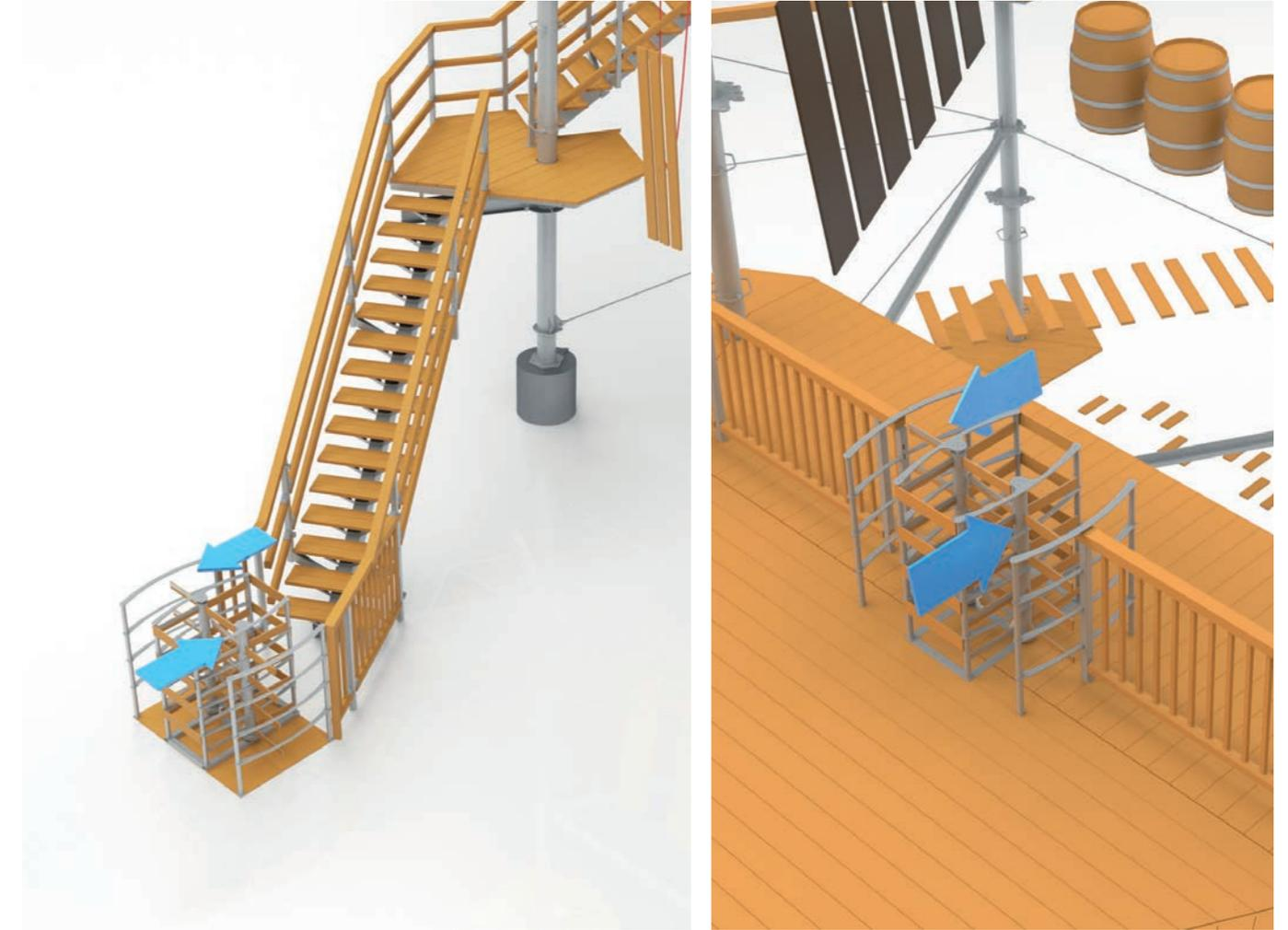
通行控制系统确保只有正确扣紧保险系统的参与者方能进入攀爬区。将两个保险环在安全绳上扣紧之后，旋转门方才能够通行。如此便可以得到妥当的保护，并在攀爬区自主移动。未保护或未经过正确保护的参与者和没有攀爬安全带的游客，将不能通行。
